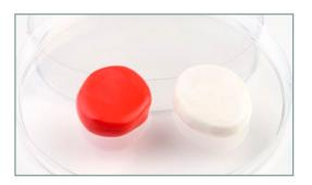
Wie Sie sehen, besteht das Abformmaterial aus einer farbigen und einer weißen Masse. Solange diese getrennt sind, sind sie in den Behältnissen unter Luftabschluss bis zu 6 Monate haltbar. Kommen sie in Kontakt miteinander, beginnt die Aushärtereaktion.
